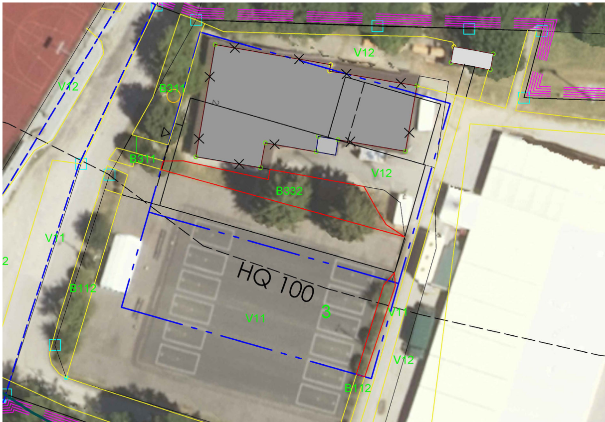
Abbildung 2: Bauparzelle 3 Bereich Asphaltbahn und Schützenheim [rotumrandet = Eingriffsfläche]
